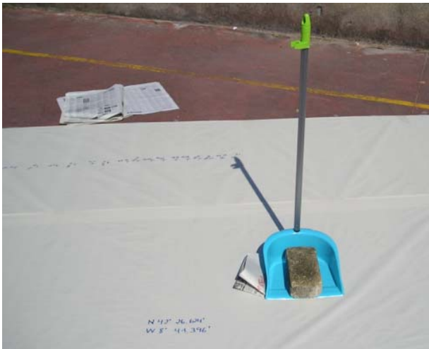
Figura 9. Procedimiento de medición de la sombra del gnomon
